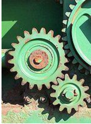
Detalle de engranaje intermedio loco.
