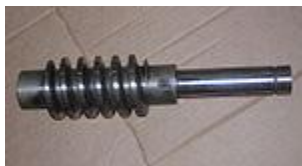
Tornillo sin fin de montacargas.
