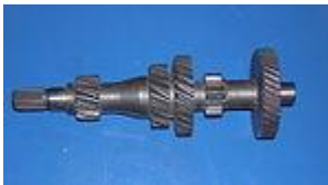
Eje primario de caja de cambios.
